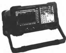
Рис. 8. Внешний вид анализатора спектра ESA-L (Agilent Technologies), модель E4404B
